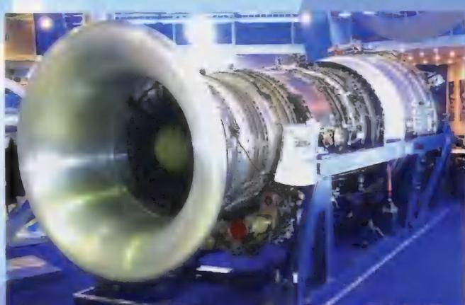
Газотурбинный привод энергоустановки ГТЭ-30-300 на базе двигателя Р79В-300
